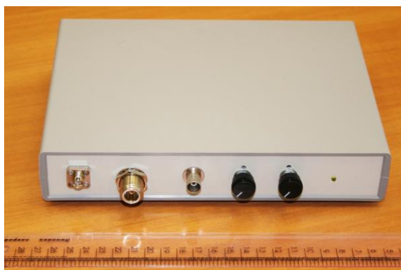
Рис.14. Макетный образец оптического передатчика, включающего одночастотный лазер А1905LMI, электрооптический модулятор SDL IOAP-MOD9170, схему автоматической стабилизации смещения модулятора
